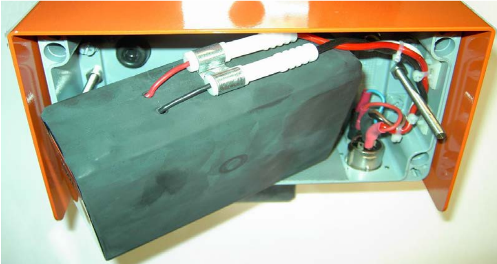
Abbildung Akkumulator bei geöffnetem Batteriegehäuse
